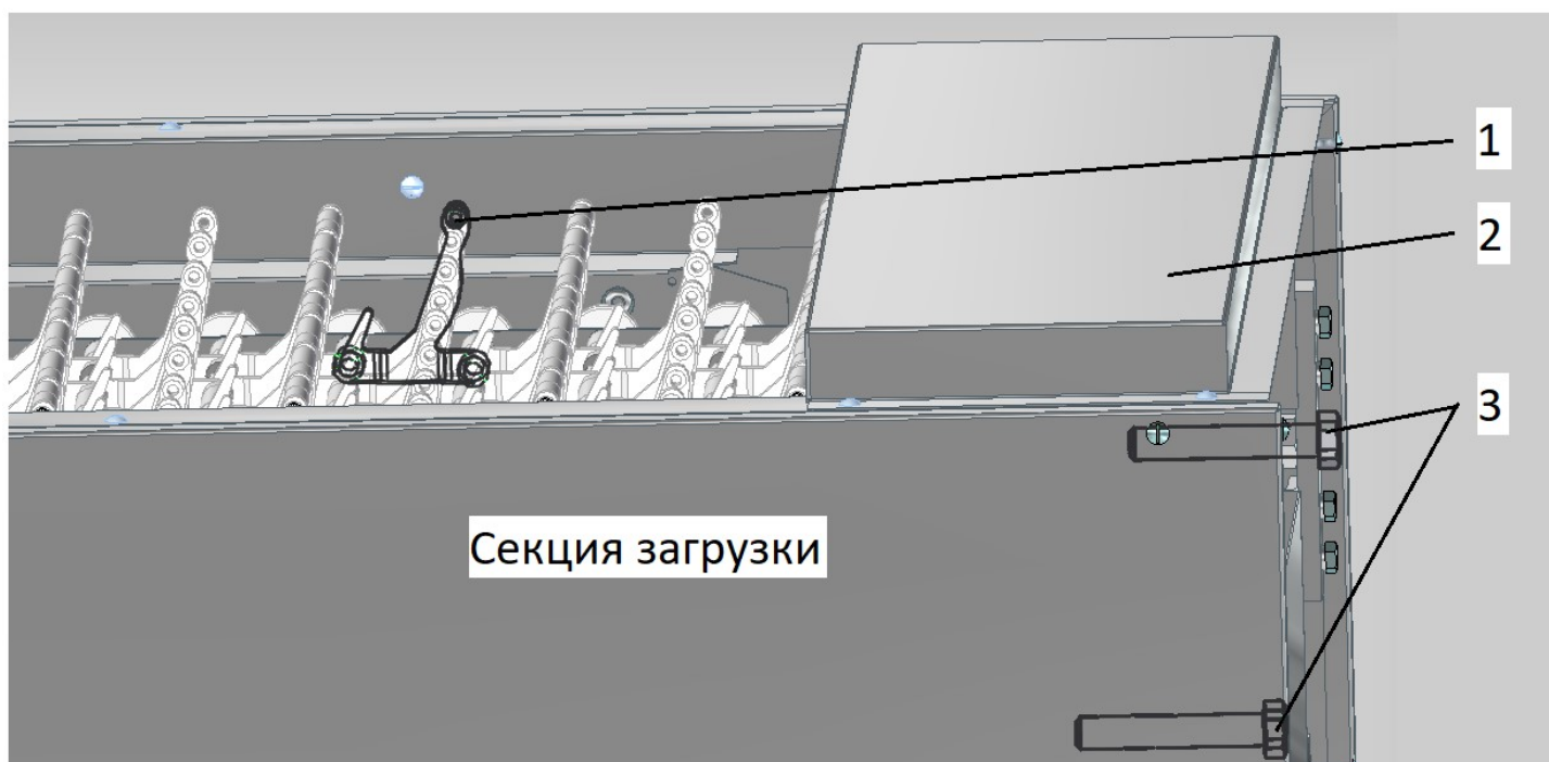
Рис. 11. Установка накладки межсекционной
